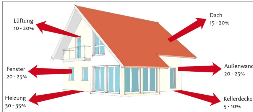
Abb. 29: Transmissionswärmeverluste im Gebäude. (Darstellung: Klimaschutzagentur Mannheim)
