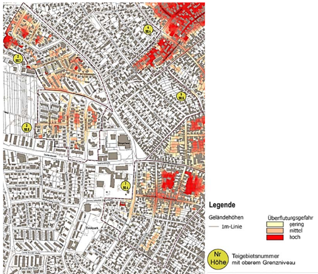
Abb. 16: Muldenlagen mit Überflutungsgefahr im Stadtgebiet. (Quelle Amt für Stadtentwicklung und Umweltplanung, Mai 2015)
